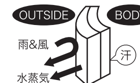
【加工】 微多孔質の膜が水滴を通さず、湿気を逃がす
